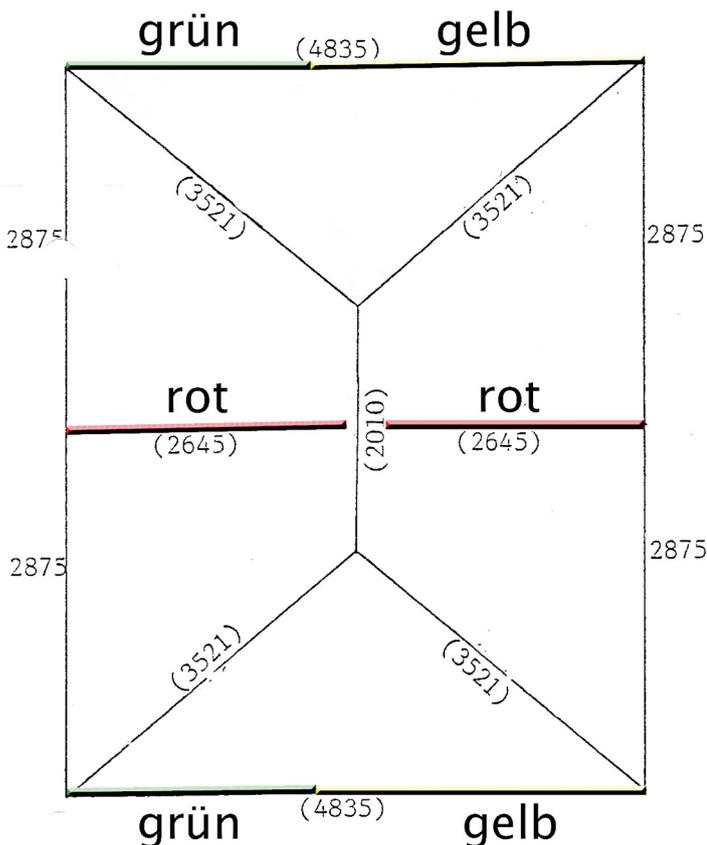
Laut Skizze I sind die Rohre des Zeltdaches incl. der Traufrohre am Boden zusammenzustecken.
